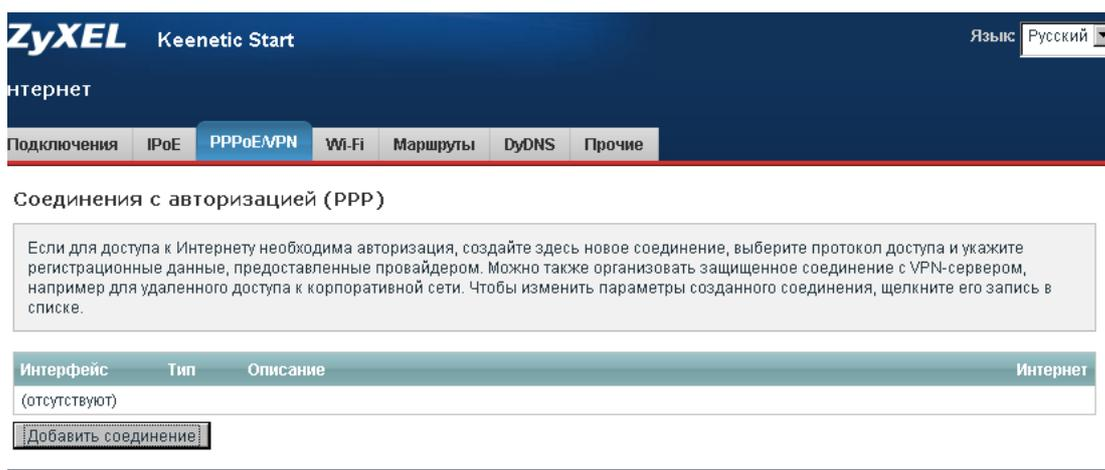
8. Настроить соединение, для чего ввести закрепленное по договору имя пользователя и пароль для доступа в сеть Интернет. Нажать кнопку «Применить»
