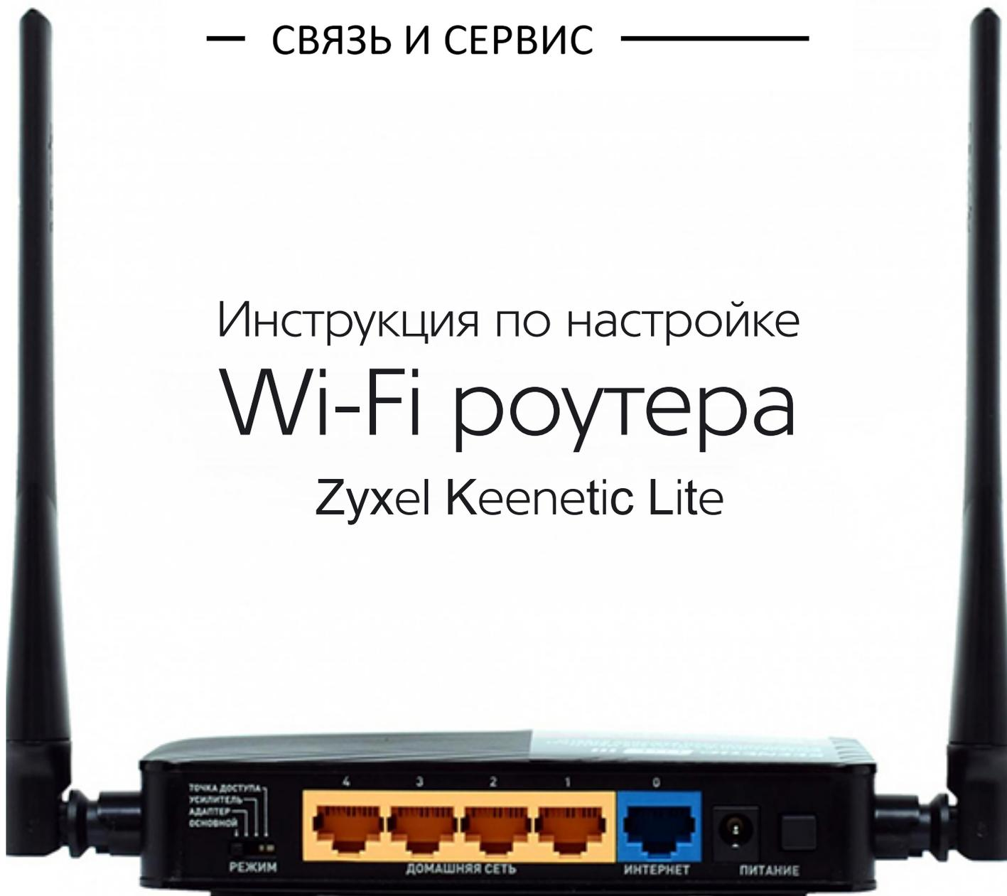
В **синее гнездо** вставляем кабель, который сотрудники компании завели к вам в квартиру. Для подключения персонального компьютера, телевизора или игровой консоли необходимо соединить устройство и роутер отдельным кабелем. Со стороны роутера этот кабель вставляется в **любое жёлтое гнездо**. Затем роутер подключаем к розетке.
